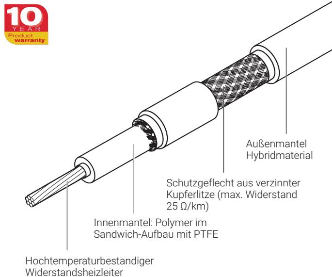
nVent RAYCHEM XPI-F ist ein polymerisiertes (PI) Heizkabel, das sich für den Einsatz in Ex- und Nicht-Ex-Bereichen eignet. Es ist ausgelegt für den Frostschutz und die Temperaturhaltung in niedrigeren Temperaturbereichen von Rohrleitungen, an Tanks und für andere Ausrüstungen.
