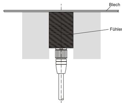
Einseitig berührende Messung mit Blechkickenfühler DSP, BDWF oder Kombinationsfühler DSPW in Kontrollstation eingebaut.
