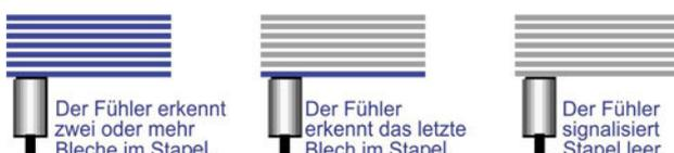
Das unterste Blech eines Stapels ist in der Regel vom Transport des Blechpaketes beschädigt und verunreinigt. Im Falle seiner Verarbeitung erhält man ein Ausschussteil und das Werkzeug wird verschmutzt.
