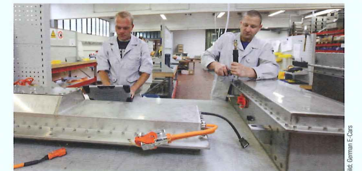
In verschraubten Edelstahl-Gehäusen integriert German E-Cars die leistungsstarken Lithium-Ionen-Akkus.
