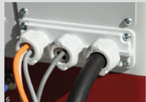
Abb. 6 Der fertig montierte UNI FLANSCH™ führt unterschiedliche Daten-, Steuer- und Energiekabel mit Schutzart IP 66 und hoher Zugentlastung.
