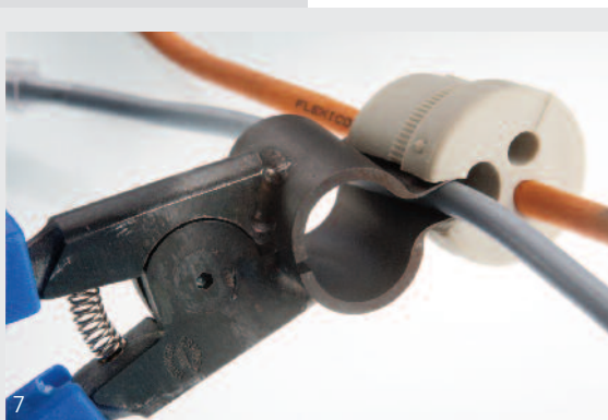
Bild 7: Mit dieser Spezialzange lassen sich Kabel einfach in die geschlitzten Dichteinsätze einführen.
