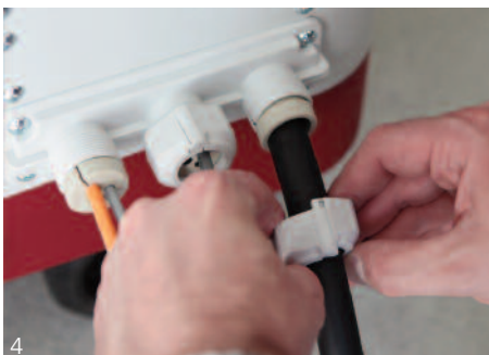
Abb. 4 Ist der UNI FLANSCH™ in der Gehäusewand verschraubt, werden die durchgeführten Kabel von den geschlitzten Dichteinsätzen umschlossen und die geteilte Druckschraube platziert.
