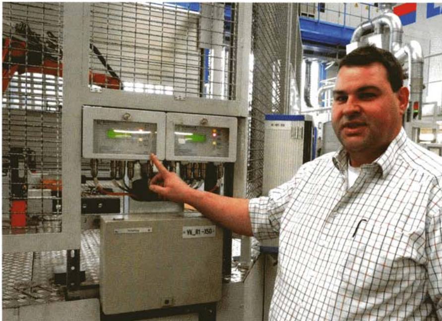
Andreas Lang , Teamleiter Wartung Elektrik bei der Läßle GmbH in Heilbronn, erläutert die Doppelblechkontrolle mit der Blechdickenfühler-Weiche von Klaschka. Dabei sind die Kontrolleinheiten sowohl mit dem jeweiligen Sensor als auch mit der Pressensteuerung verbunden.
