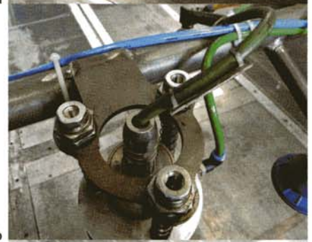
Andreas Lang , Teamleiter Wartung Elektrik bei der Läßle GmbH in Heilbronn, erläutert die Doppelblechkontrolle mit der Blechdickenfühler-Weiche von Klaschka. Dabei sind die Kontrolleinheiten sowohl mit dem jeweiligen Sensor als auch mit der Pressensteuerung verbunden.
